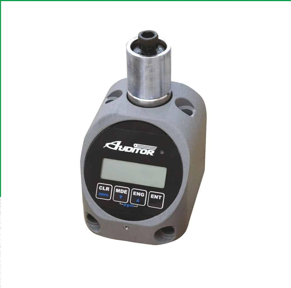
AUDITOR TORQUE CUBE è un tester portatile e compatto in grado di verificare utensili a pistola o diritti. Il kit giunzione con rondelle Belleville rende semplice la configurazione e simulazioni di giunzioni rigide o morbide.
