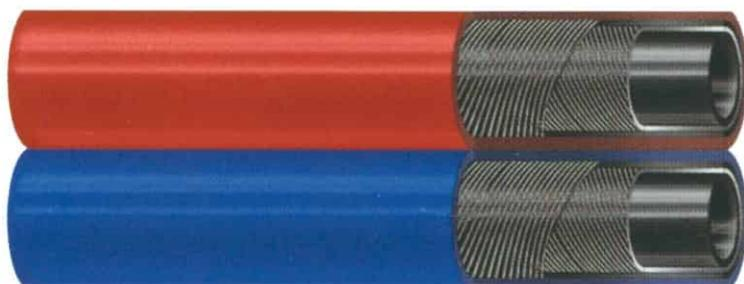
Tubo mandata ossigeno e acetilene in gomma sbr con sottostrato liscio nero, rinforzo con inserzioni tessili e copertura esterna in gomma sbr/epdm liscia rossa, resistente agli agenti atmosferici e all'invecchiamento. Prodotto secondo norme ISO 3821
