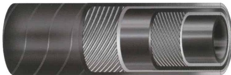
Tubo per acqua calda in gomma epdm con sottostrato liscio nero resistente al calore, rinforzo con inserzioni tessili e copertura esterna in gomma epdm liscia nera ad impressione tela, resistente all'abrasione all'invecchiamento ed agli agenti atmosferici.
