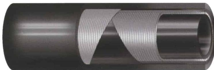
Tube per acqua calda long length. In gomma epdm con sottostrato liscio nero resistente al calore, rinforzo con inserzioni tessili e copertura esterna in gomma epdm liscia nera, resistente all'abrasione, all'invecchiamento al calore ed agli agenti atmosferici.
