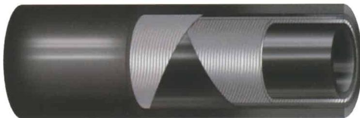
Tube in gomma sbr con sottostrato liscio nero, rinforzo con inserzioni tessili e copertura esterna in gomma sbr/epdm liscia nera, resistente all'abrasione ed agli agenti atmosferici.
