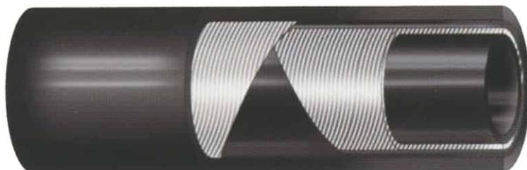
Tubo mandata carburanti ed olii minerali in gomma nbr conduttivo con sottostrato liscio nero, rinforzo con inserzioni tessili e copertura esterna in gomma nbr/pvc liscia nera, resistente agli olii, ai carburanti, agli agenti atmosferici e all'ozono.
