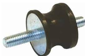
Sono costituiti da un cilindro in gomma naturale, e da una armatura in acciaio zincato. Caratterizzati da una elasticità radiale superiore a quella assiale, possono lavorare a compressione oppure a taglio a secondo delle condizioni di montaggio. È l'antivibrante più semplice, di ingombro minimo e viene catalogato in base al tipo di fissaggio e alle dimensioni delle parti filettate.
