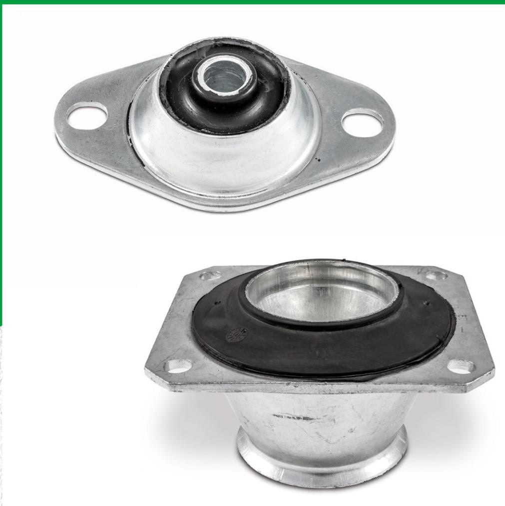
I supporti antivibranti conici sono caratterizzati da alti cedimenti assiali e limitati cedimenti radiali. Sono forniti completi di rondelle che limitano i movimenti in caso di urti. Vengono utilizzati spesso come supporti cabina, e in applicazioni mobili. A richiesta possono essere forniti anche con alcuni scarichi nella parte in elastomero per permettere cedimenti superiori.
