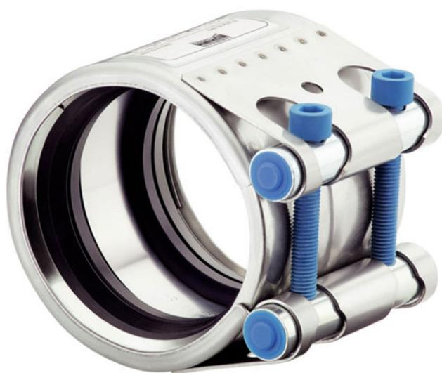
I giunti per tubi NORMACONNECT® FLEX E vengono utilizzati per collegare tubi rigidi, tubi in metallo, acciaio, cemento e plastica. Con i giunti per tubi NORMACONNECT® FLEX E, la sicurezza di tenuta è garantita anche quando l'estremità dei tubi sono distanti, grazie alla capacità di compensazione del giunto. Con tubi di diametro esterno >180 mm il tipo FLEX E per applicazioni a bassa pressione.
