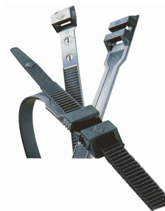
Collare di fissaggio in nylon 612 di colore nero. L'aggancio avviene per deformazione della testa e contrasto tra la cremagliera e i denti fissi. Particolarmente adatti per lavorare in ambiente atmosferico, anche marino.
