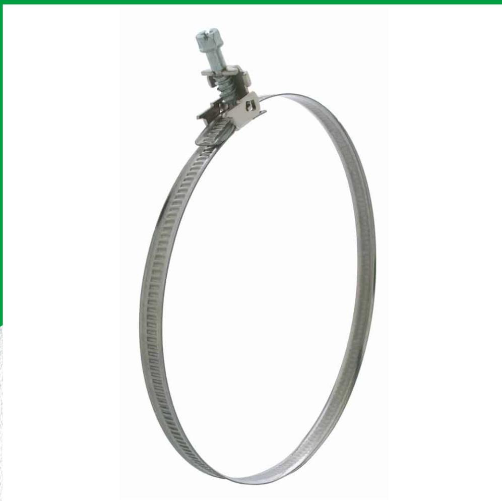
Le fascette con carrello ribaltabile 9 mm sono realizzate con anello a cremagliera stampata su tutta la lunghezza del nastro e bordi arrotondati per evitare il danneggiamento del tubo. Caratteristica di questa fascetta è il cassetto con vite ribaltabile, che favorisce rapidità nell'installazione grazie all'aggancio automatico che intercetta il giusto diametro del tubo.
