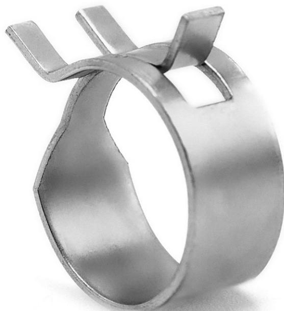
Le fascette a molla permettono ripartire in modo uniforme la pressione sulla zona di applicazione. Sono ideali per flessibili esposti a contrazioni e dilatazioni causate dalle variazioni di temperatura in quanto mantengono il diametro costante.
