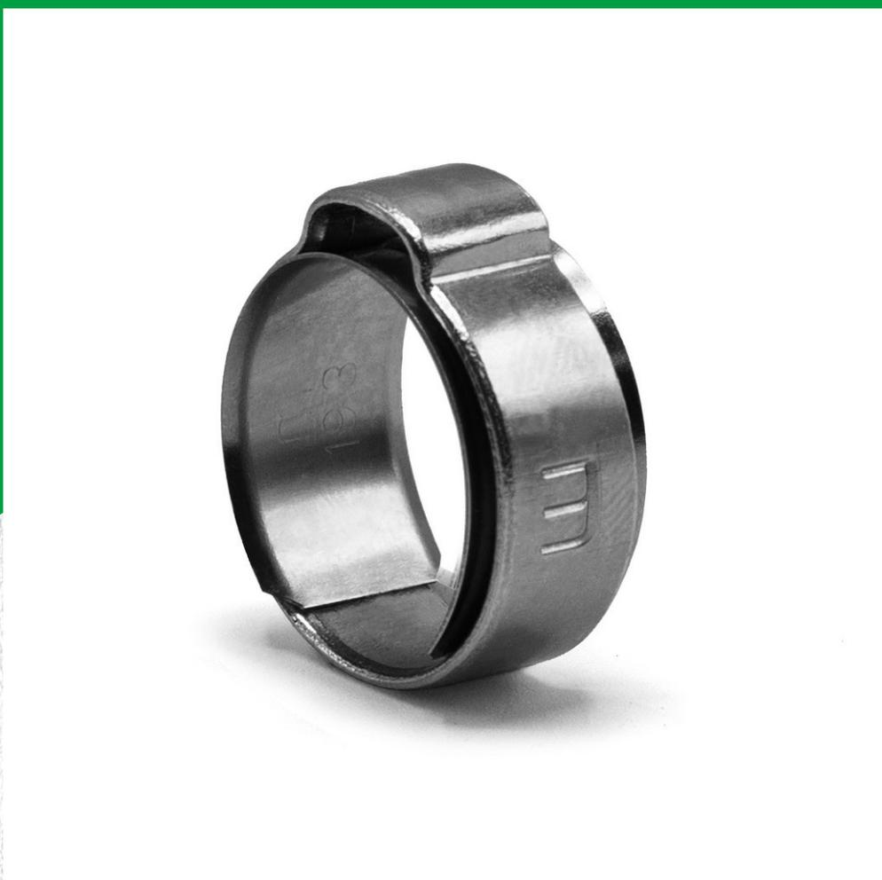
Le fascette ad orecchie rappresentano una soluzione semplice ed economica. Il montaggio è facile e veloce. La fascetta viene infilata sul materiale da montare e poi bloccata mediante l'apposito utensile. La versione con anello di protezione evita grinze e schiacciamenti del tubo in fase di montaggio.
