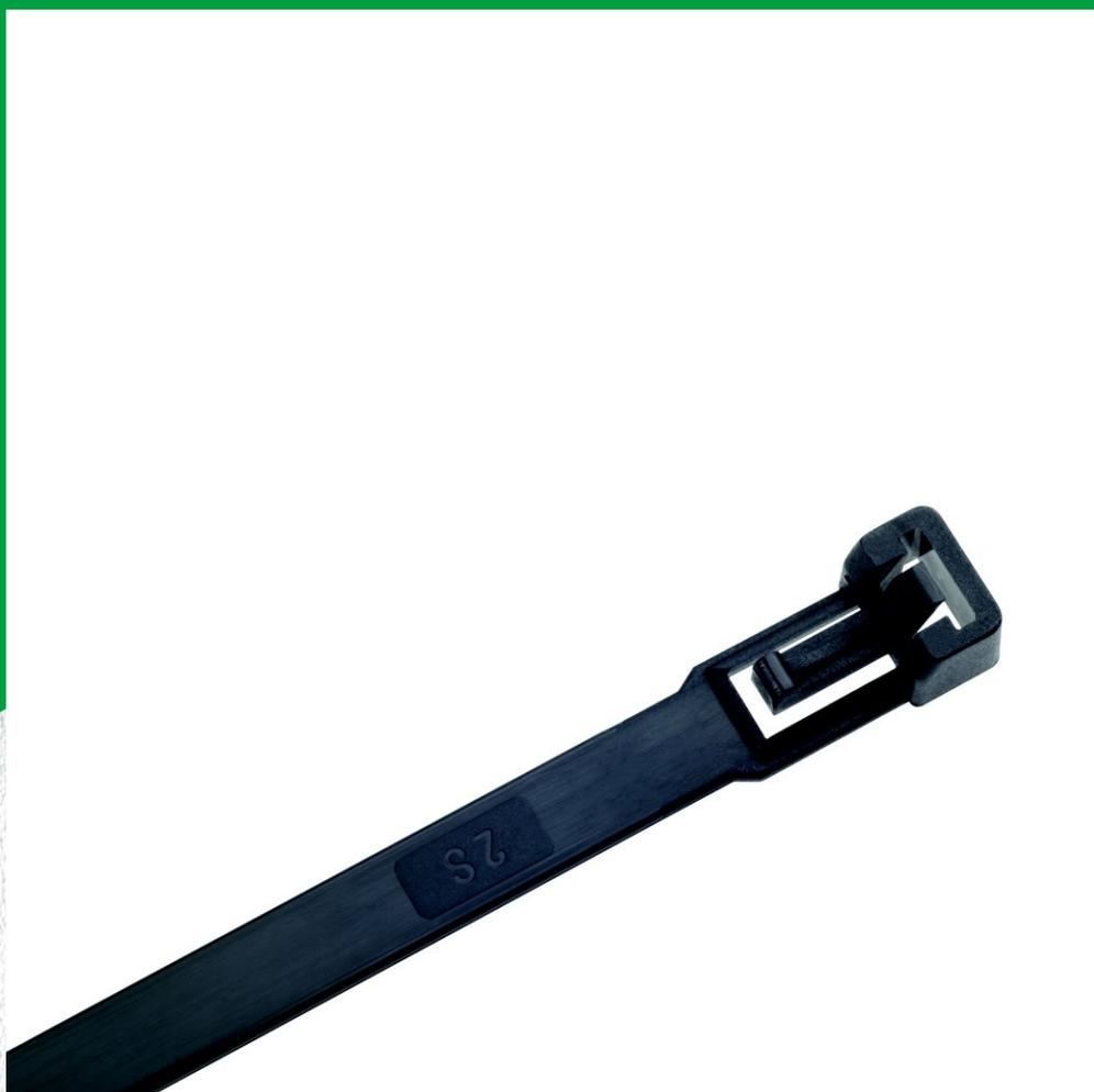
Le fascette riapribili in nylon sono progettate per fissare e/o unire facilmente i cavi e i fili elettrici. A differenza delle fascette tradizionali, progettate per essere utilizzate una sola volta, le fascette riapribili possono essere facilmente aperte e chiuse, consentendo una facile regolazione e un riutilizzo in base alle necessità.
