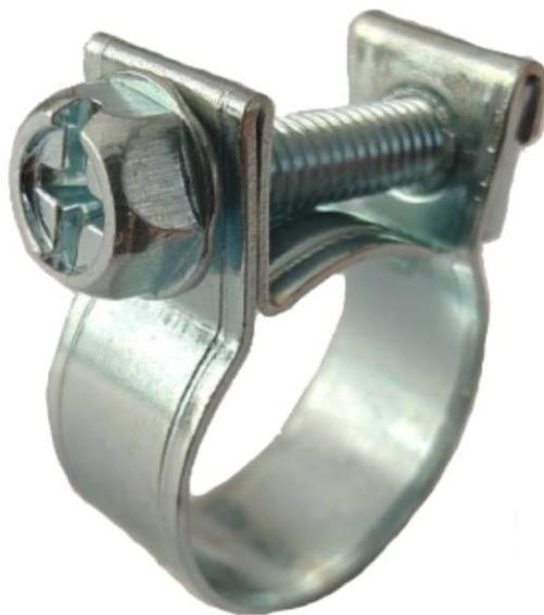
I collari mini benzina hanno un nastro a bordi rialzati per non danneggiare il tubo e la linguetta inferiore è munita di rinforzo. Un altro dettaglio pratico è la testa esagonale della vite, dotata di intaglio e adatta per l'utilizzo di un cacciavite flessibile. È particolarmente indicato per tubi di piccolo diametro e di spessore ridotto.
