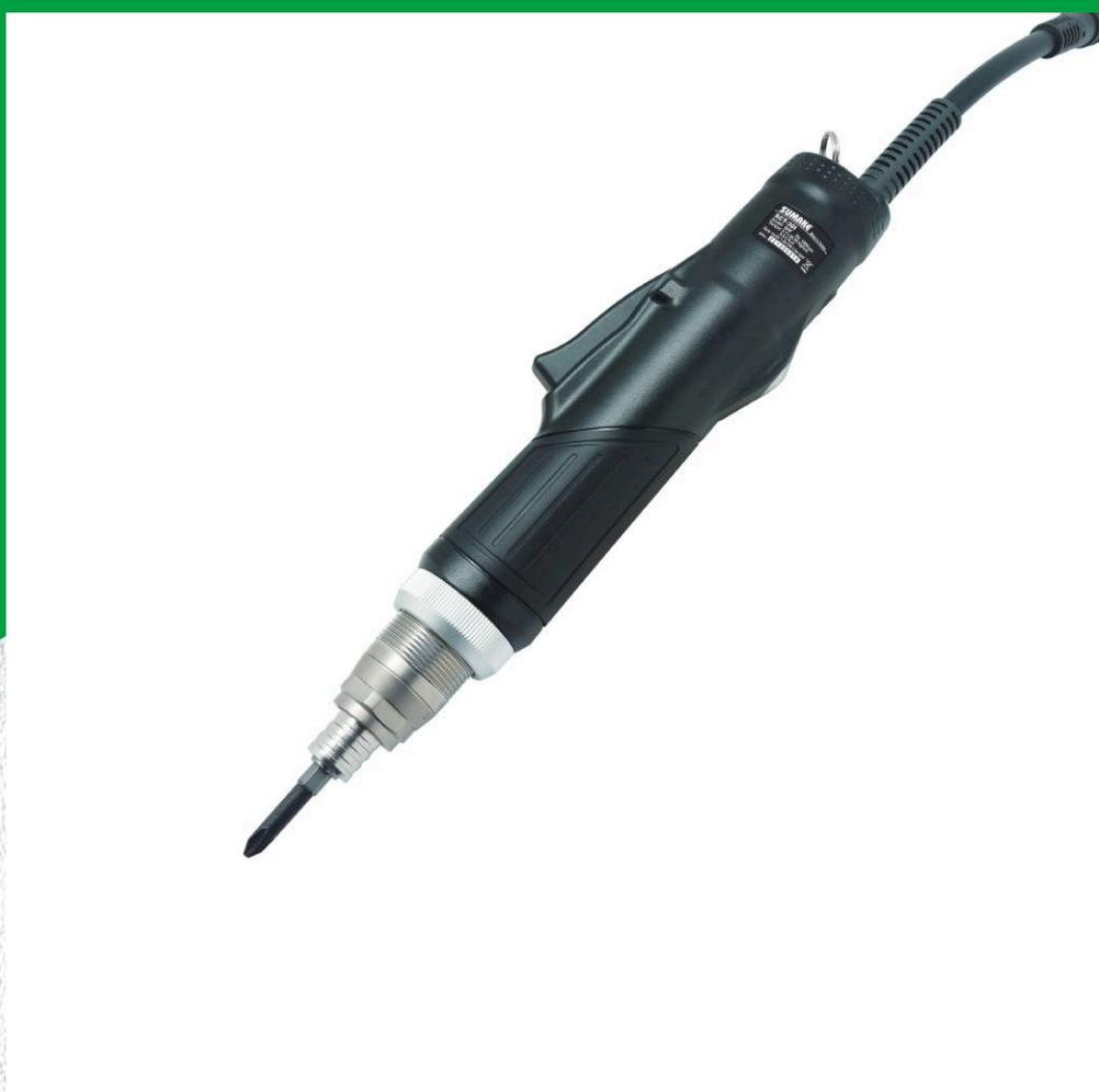
La serie SCT è il sistema di avvitatura elettronico intelligente di Sumake con controllo amperometrico della coppia e dell'angolo.
