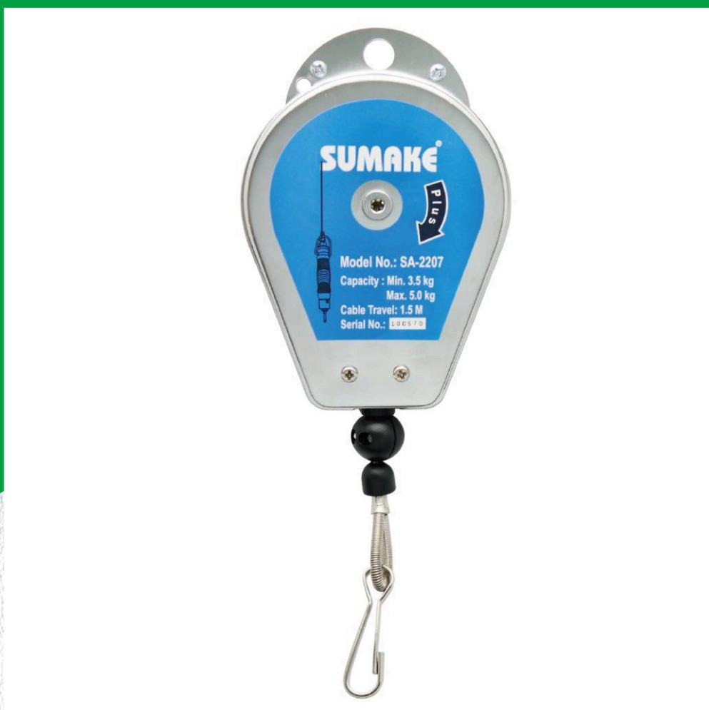
Il bilanciatore industriale è progettato con un meccanismo a spirale che garantisce un funzionamento fluido e controllato. L'aumento del diametro della vite è compensato da una maggiore forza della molla, assicurando un equilibrio costante della forza in uscita. Questo consente all'operatore di posizionare e mantenere lo strumento esattamente nel punto desiderato, riducendo lo sforzo e migliorando l'ergonomia durante l'uso.
