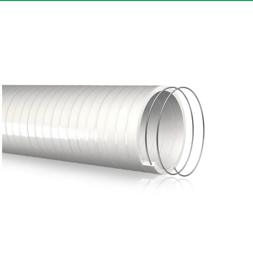
Tubo fabbricato per coestrusione di prodotti vinilici di primaria qualità con spirale rigida in acciaio armonico galvanizzato. Sottostrato prodotto con una miscela speciale in elastomero termoplastico anti odore che ne migliora le performance di utilizzo e durabilità.
