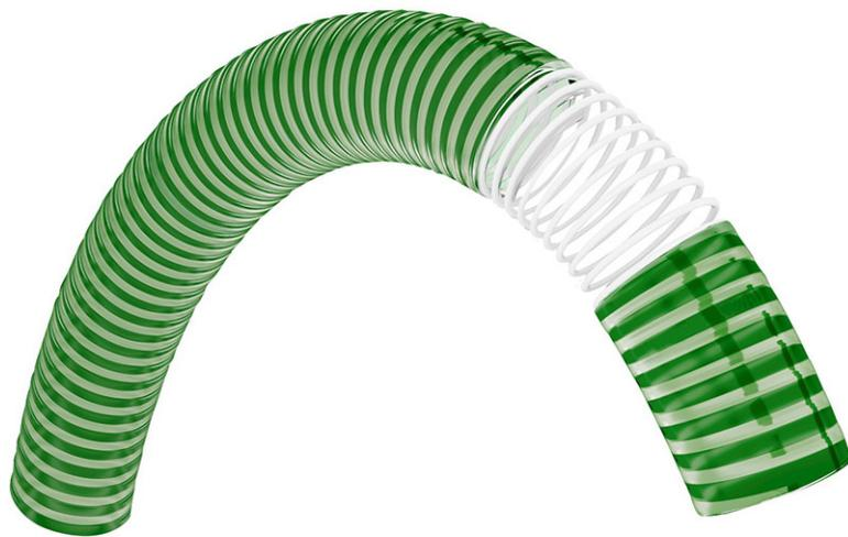
Tubo fabbricato per coestrusione di prodotti vinilici di primaria qualità, con spirale rigida in PVC antiurto. Buona resistenza agli agenti atmosferici e a numerose sostanze chimiche secondo le proprietà standard del PVC. Idoneo per il trasporto di liquidi alimentari secondo le normative europee CE 1935/2004 e UE 10/2011 (simulanti A,B,D,D1 e D2) con tenore alcolico fino a 50°.
