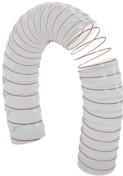
Tubo fabbricato in PU (poliuretano) di primaria qualità, con spirale rigida in acciaio armonico ramato incorporata. Buona resistenza agli agenti atmosferici e a numerose sostanze chimiche secondo le proprietà standard del PU. Idoneo al passaggio di prodotti alimentari secchi. Ottima resistenza al passaggio di prodotti abrasivi. Possibilità di rendere il tubo antistatico collegando a terra la spirale.
