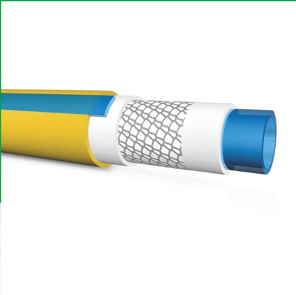
Tubo fabbricato per coestrusione di prodotti vinilici di primaria qualità, con rinforzo tessile magliato in poliestere. Buona resistenza agli agenti atmosferici e al passaggio di prodotti chimici secondo le proprietà standard del PVC. Idoneo per il trasporto di liquidi alimentari secondo le normative europee CE 1935/2004 e UE 10/2011 (simulanti A,B,C).
