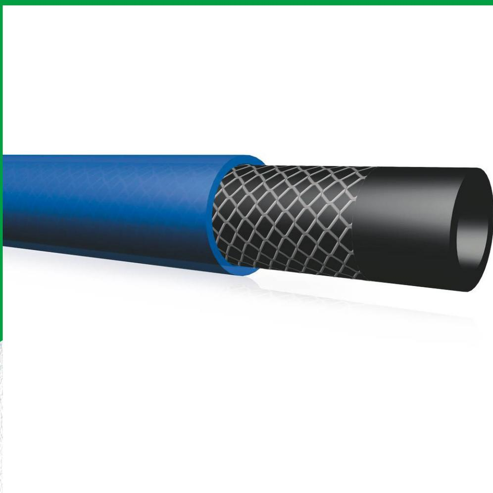
Tubo fabbricato per coestrusione di prodotti vinilici di primaria qualità, con rinforzo tessile retinato in poliestere. Buona resistenza agli agenti atmosferici e al passaggio di prodotti chimici secondo le proprietà standard del PVC.
