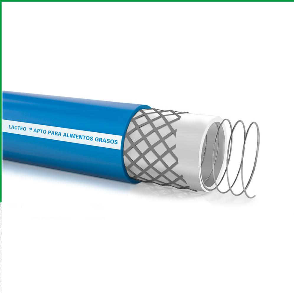
Tubo fabbricato con uno speciale elastomero termoplastico di primaria qualità, con spirale rigida in acciaio armonico galvanizzato, e con rinforzo tessile retinato in poliestere. Buona resistenza agli agenti atmosferici e a numerose sostanze chimiche.
