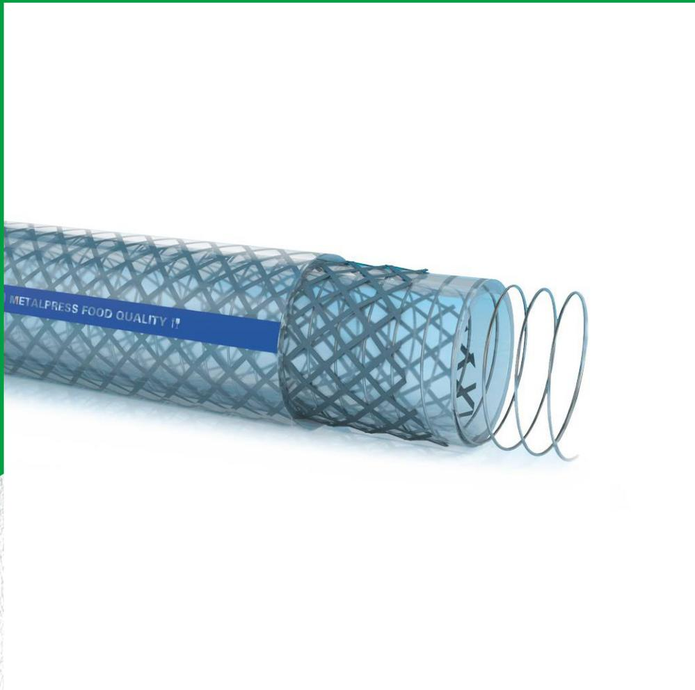
Tubo fabbricato per coestrusione di prodotti vinilici di primaria qualità, con spirale rigida in acciaio armonico galvanizzato, e con rinforzo tessile retinato in poliestere. Buona resistenza agli agenti atmosferici e al passaggio di prodotti chimici secondo le proprietà standard del PVC. Idoneo per il trasporto di liquidi alimentari secondo le normative europee CE 1935/2004 e UE 10/2011 (simulanti A,B,C) con tenore alcolico fino a 20°.
