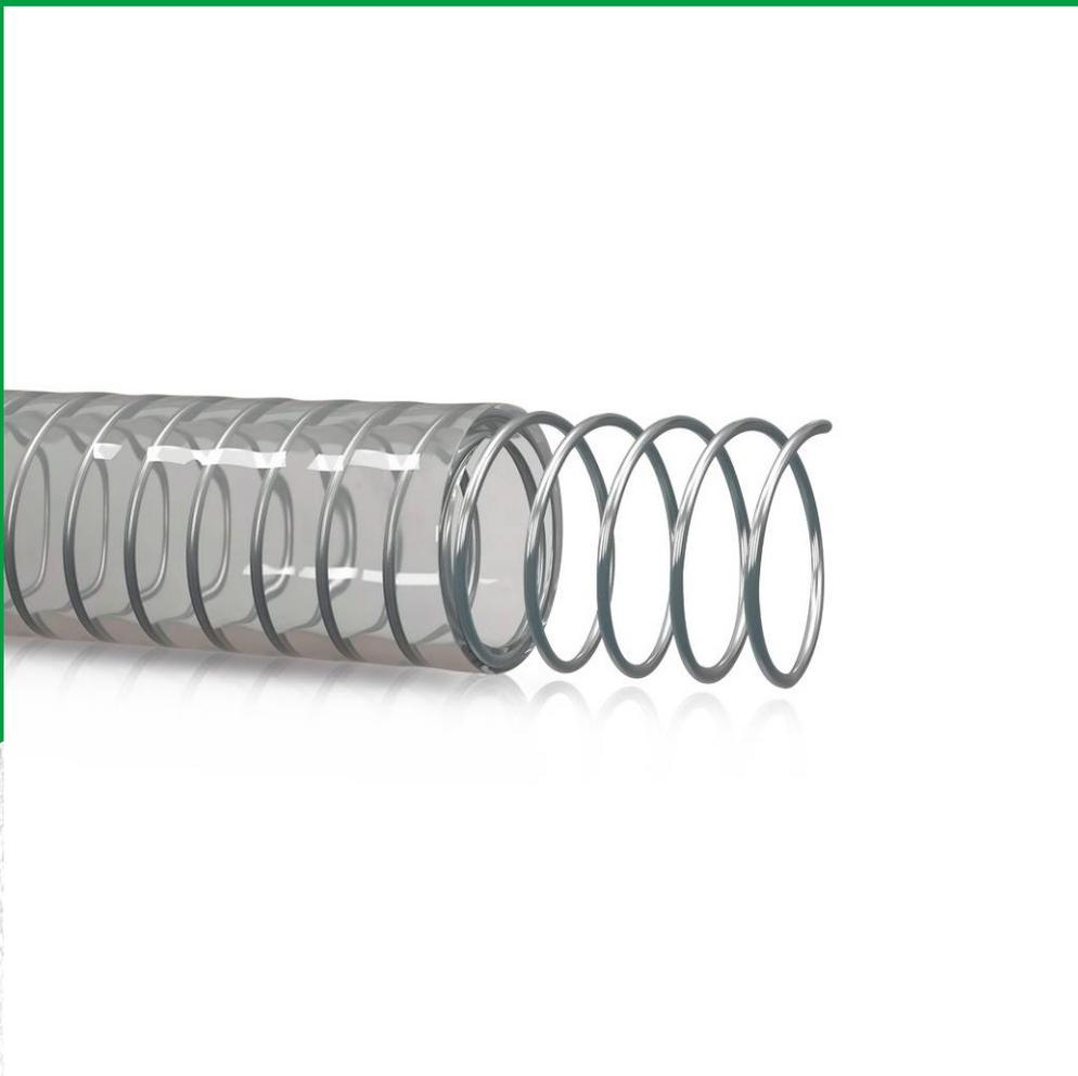
Tubo fabbricato per coestrusione di prodotti vinilici di primaria qualità, con spirale rigida in acciaio armonico galvanizzato.
