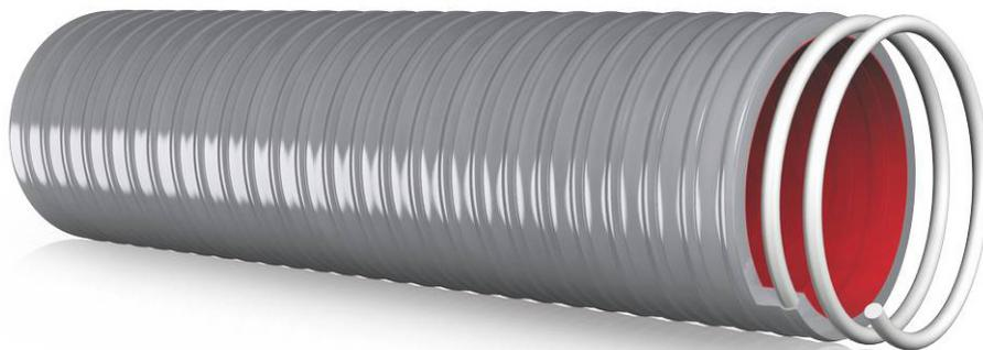
Tubo fabbricato per coestrusione di prodotti vinilici di primaria qualità, con spirale rigida in PVC antiurto. Sottostrato in PU (poliuretano) che ne conferisce elevata resistenza all'abrasione. Buona resistenza agli agenti atmosferici e a numerose sostanze chimiche secondo le proprietà standard del PU.
