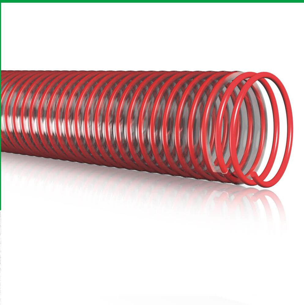
Tubo fabbricato per coestrusione di prodotti vinilici di primaria qualità, con spirale rigida in PVC antiurto. Buona resistenza agli agenti atmosferici e al passaggio di prodotti chimici secondo le proprietà standard del PVC. Idoneo per il trasporto di liquidi alimentari secondo le normative europee CE 1935/2004 e UE 10/2011 (simulanti A,B,C,D1) con tenore alcolico fino a 50°. Prove di migrazione eseguite a 40°C per 10 giorni.
