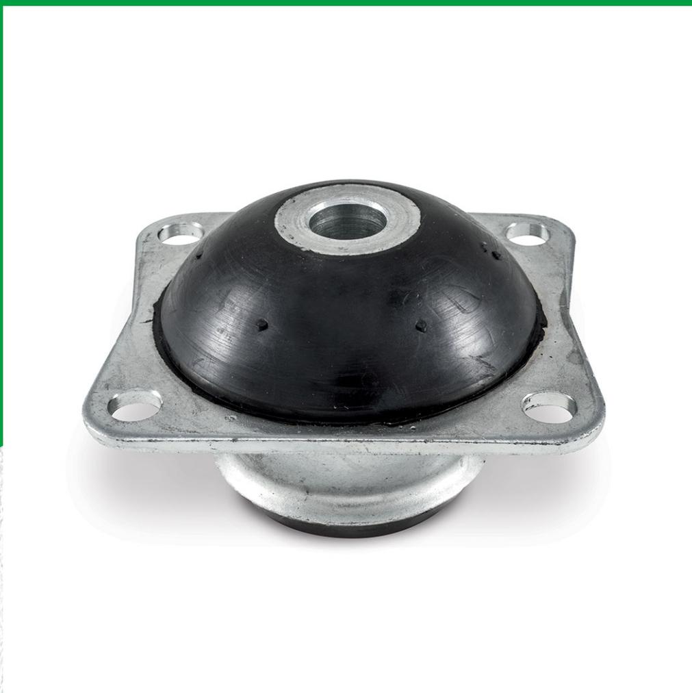
Antivibranti in gomma e metallo. I supporti antivibranti conici asolati presentano delle asole nella parte gommata per supportare cedimenti in senso assiale abbinati ad elevati cedimenti in senso radiale. Sono forniti completi di rondelle di trazione e compressione che limitano i movimenti in caso di urti. A richiesta possono essere forniti anche con alcuni scarichi nella parte in elastomero per permettere cedimenti superiori.
