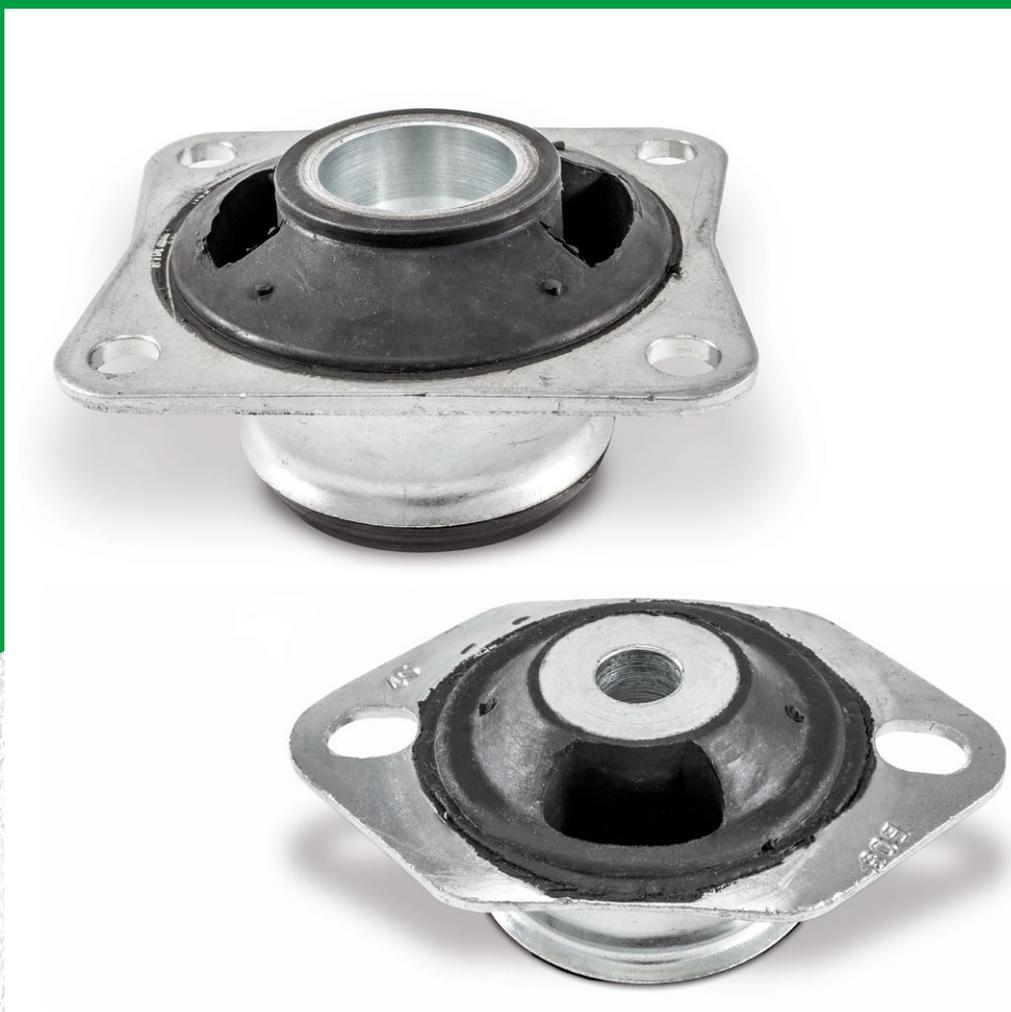
I supporti antivibranti conici asolati presentano delle asole nella parte gommata per supportare cedimenti in senso assiale abbinati ad elevati cedimenti in senso radiale. Sono forniti completi di rondelle di trazione e compressione che limitano i movimenti in caso di urti. A richiesta possono essere forniti anche con alcuni scarichi nella parte in elastomero per permettere cedimenti superiori.
