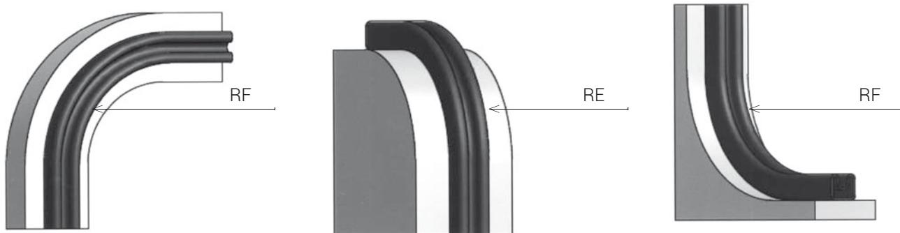
**raggio di curvatura minimo in mm**
